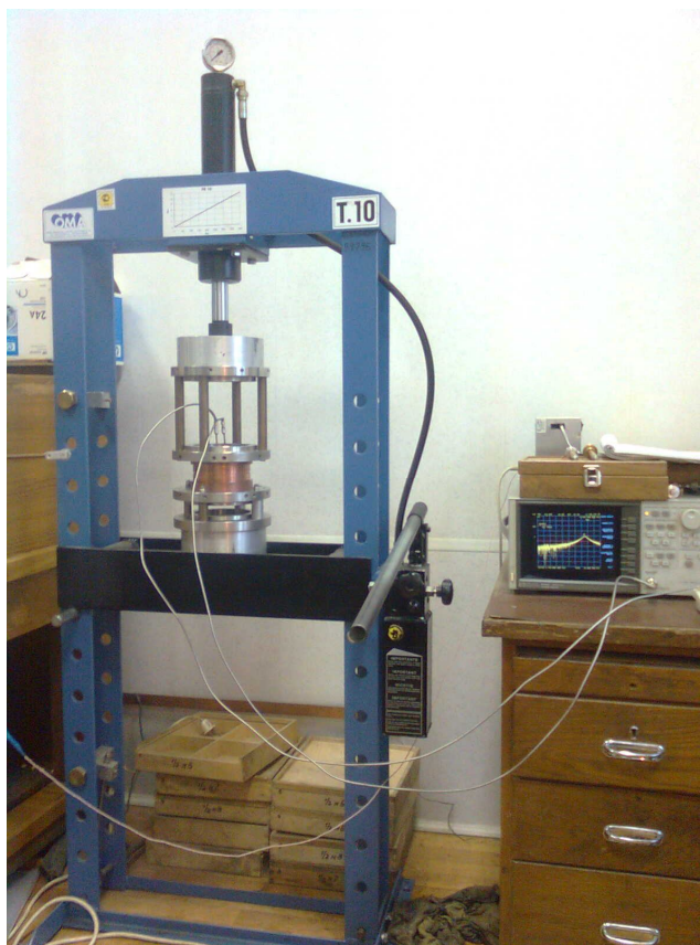
Рис. 9. Общий вид стенда для измерений и настройки параметров ячеек ускоряющей структуры в целом.
