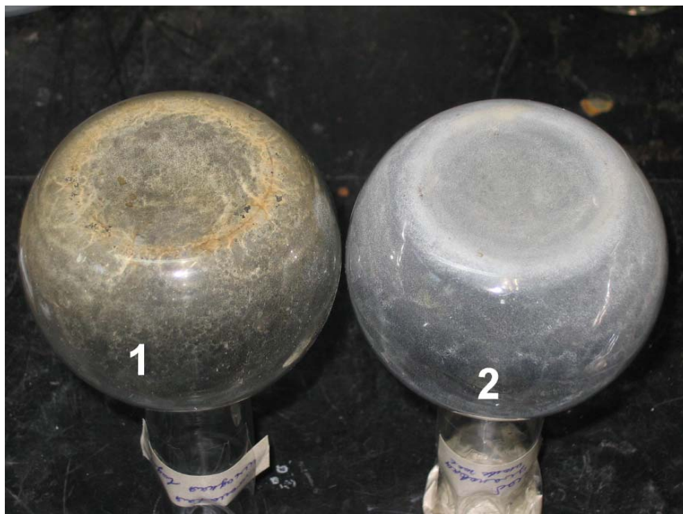
Рисунок 10. Осадок от выпаривания 0,5 л воды: 1 - водопроводная вода; 2 - вода, очищенная установкой серии Пилимин.
