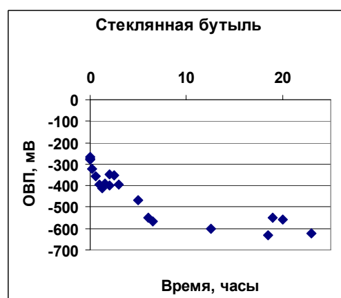
Рисунок 28. Установление ОВП в первые часы после введения водорода. Жидкость - вода, очищенная установкой БЭР-49-М. Количество вводимого водорода 40 \div 50 мл. Слева - пластиковая бутылка, справа - стеклянная. Объем бутылки 0,5 л. Слева - пластиковые бутылки, справа - стеклянные бутылки с закручивающимися металлическими пробками. Первая точка на всех графиках получена при времени выдержки бутылки с водородом 2 минуты.
