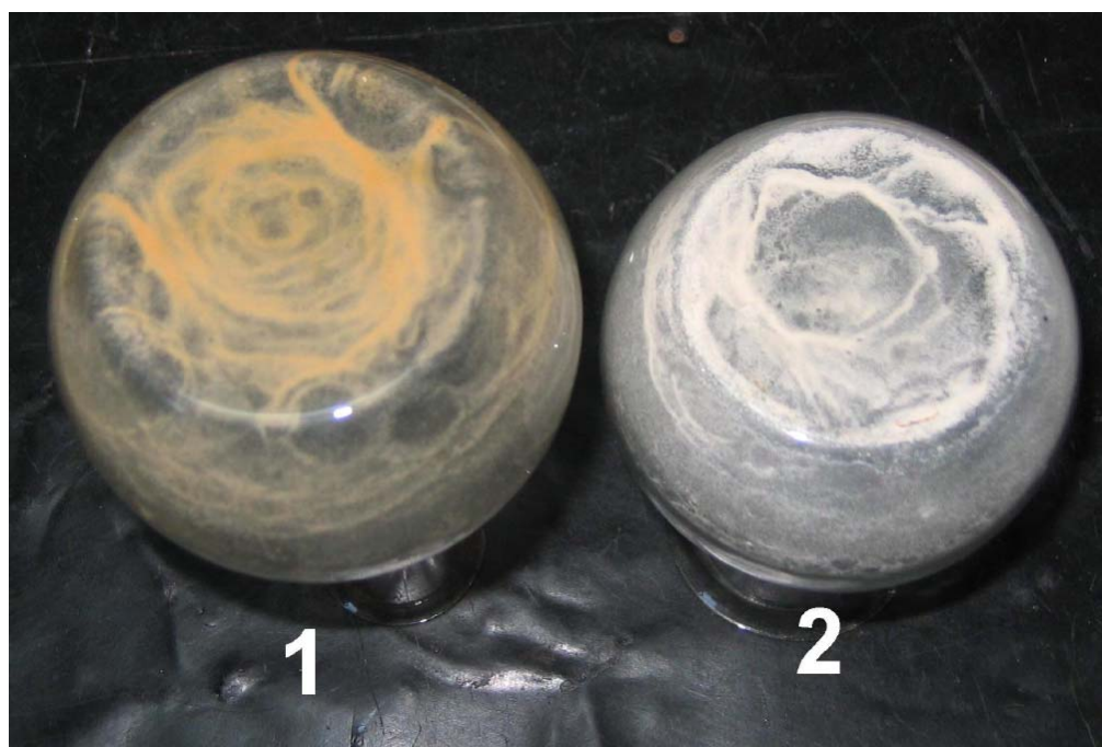
Рисунок 12. Осадок от выпаривания воды из родника, бьющего в поле (колба 1), и колодезной воды с нормальным содержанием солей (колба 2).
