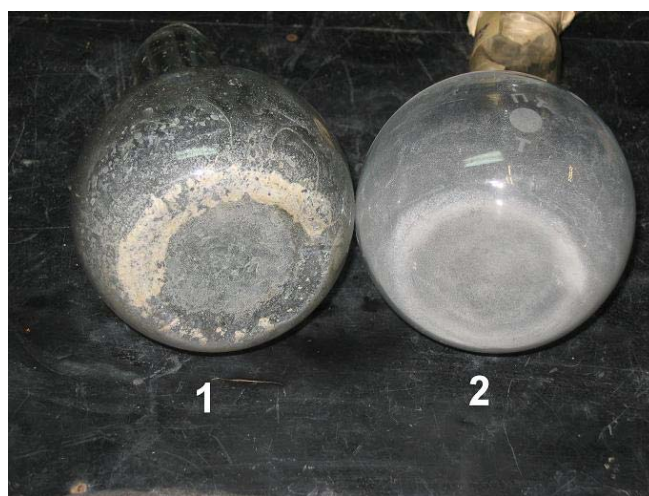
Рисунок 19. Полностью выпаренный осадок колодезной воды: 1 - пропущенной через угольный фильтр; 2 - исходной.
