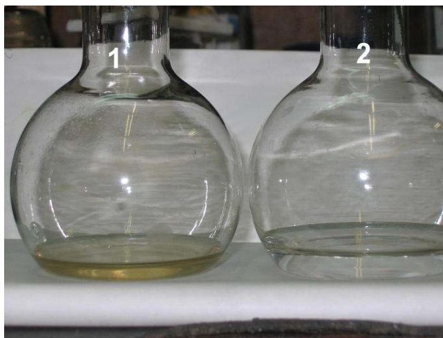
Рисунок 18. Остаток после частичного выпаривания колодезной воды: 1 - пропущенной через угольный фильтр; 2 - исходной.
