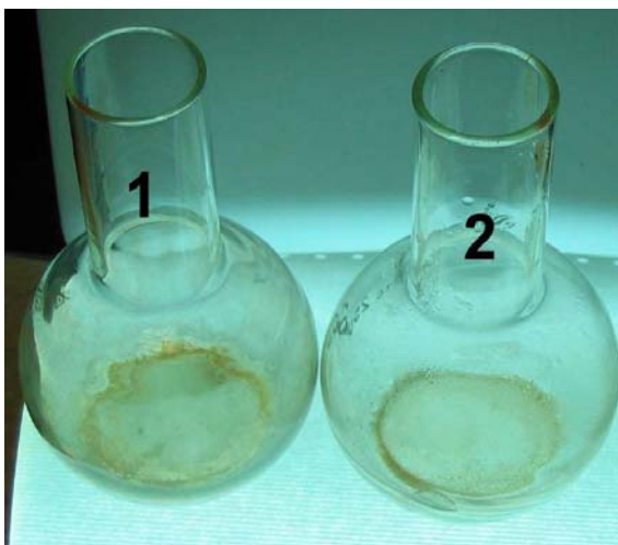
Рисунок 16. Осадок от выпаривания проб воды объёмом 0,5 литра: 1 - исходная водопроводная вода, 2 - вода после пористого титанового фильтра.
