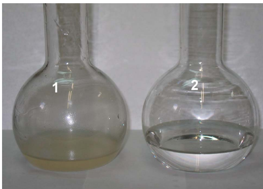
Рисунок 9. Остаток от выпаривания 0,5 л воды на конечной стадии. Объём колбы 250 мл. 1 - вода водопроводная; 2 - вода дистиллированная.
