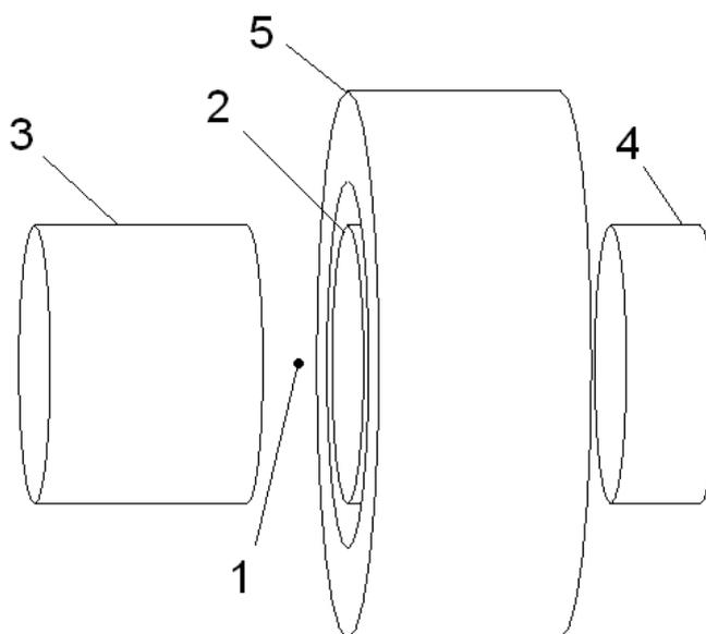
**Рис. 4.** Различные варианты схем совпадений. 1 – источник гамма-квантов, 2 – основной детектор, 3 – детектор, регистрирующий гамма-кванты, рассеявшиеся под большим углом, 4 – детектор,
