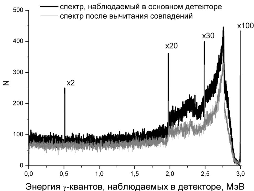
**Рис. 5. Сравнение спектра, измеренного основным детектором, и спектра, полученного после вычитания совпадений по схеме 3.**
