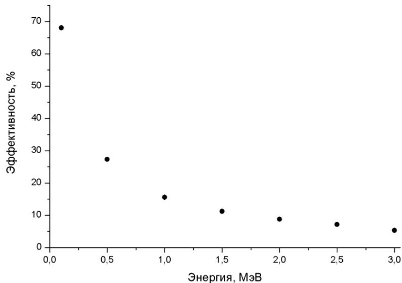
Рис. 2. Зависимость эффективности регистрации детектором фотопика от энергии падающих на детектор гамма-квантов.
