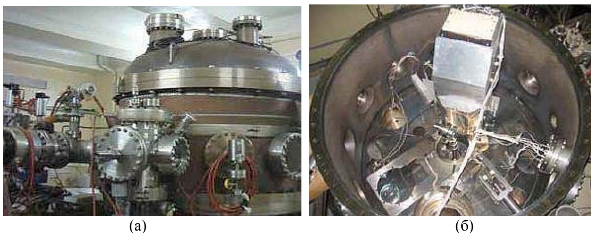
Рис.3. Камера MEIS в комплексе КГ-MEIS: (а) внешний вид, (б) вид сверху.
