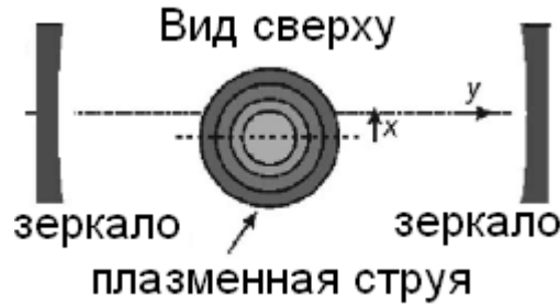
Рис. 4.11. Схема экспериментальных измерений [80] линейных концентраций со смещением лазерной системы (луча y ) на расстояние x от центра струи.
