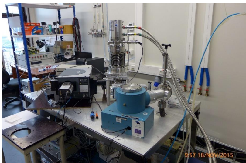
Рисунок 2.11. Экспериментальная установка для ВУФ люминесцентной спектроскопии в лаборатории ионных кристаллов в Институте Физики Тартуского университета.
