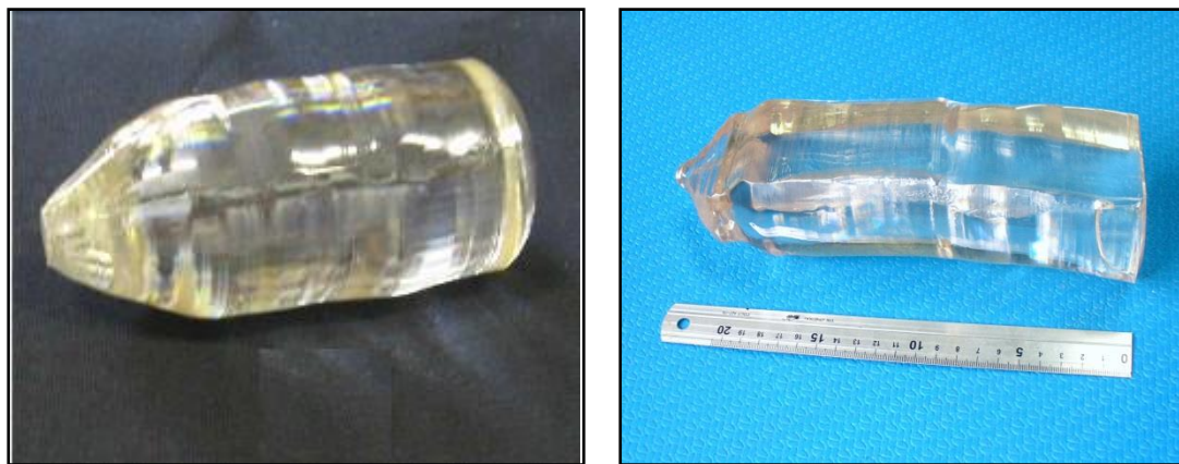
Рис. 2.2. Монокристаллы ZnWO_4 , выращенные методом Чохральского в Институте монокристаллов НАН Украины (слева) и Институте неорганической химии СО РАН (справа).
