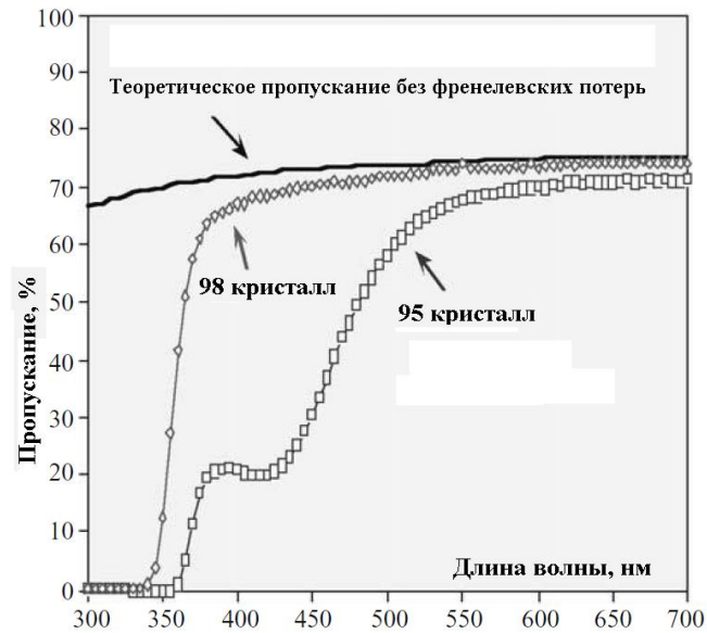
Рис. 1.8. Спектральная зависимость оптического пропускания в продольном направлении кристаллов \text{PbWO}_4 длиной 23 см [35].
