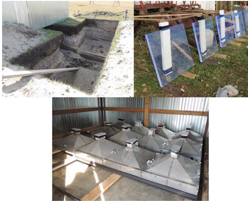
Рис.2.7. a) подготовка подвала для мюонного детектора; b) сцинтилляционные пластины; c) вид на детектор электронов внутри станции.
