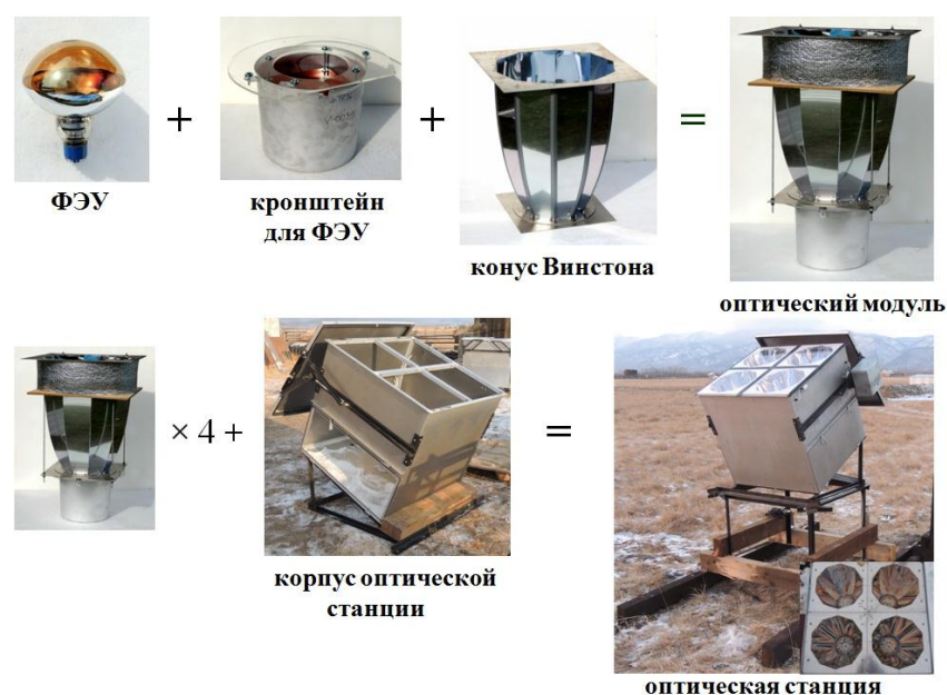
Рис.2.2. Конструкция и элементы оптической станции установки Tunka-HiSCORE
