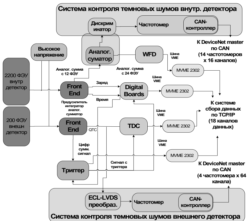
Рис. 4. Блок-схема аппаратной части системы контроля и сбора данных Борексино.
