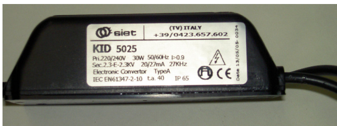
Рис. 14. Промышленный электронный преобразователь для питания барьерного разряда – высоковольтный источник переменного напряжения с частотой 27 кГц. Мощность преобразователя 30 Вт.
