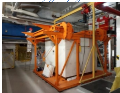
Детектор iDREAM на Калининской АЭС в подреакторном помещении третьего энергоблока
